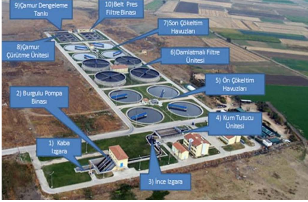
Şekil 1 Atıksu Arıtma Tesisi Örnek Yerleşim Planı
