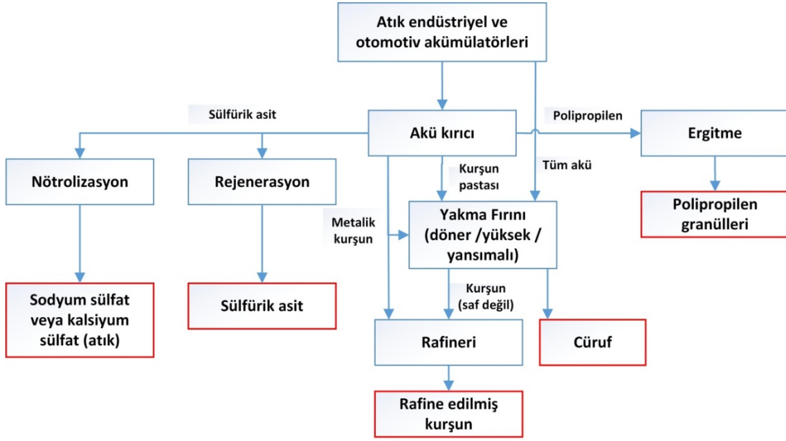
Şekil 8 Kurşun/Asit Akümülatör Geri Dönüşüm Proses Akım Şeması [ 8]
