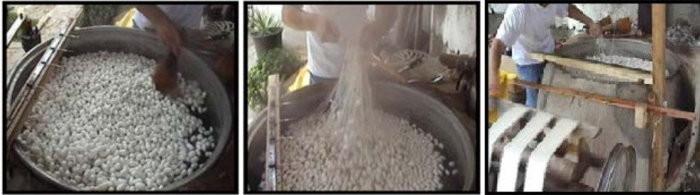
Şekil 2. Koza pişirme filament çekme [3]
