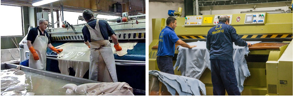
Şekil 7 Sıkma [3] ve Traşlama [7]
